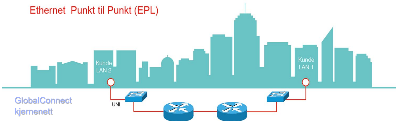
Figur 1. Prinsippskisse Ethernet Punkt til punkt
